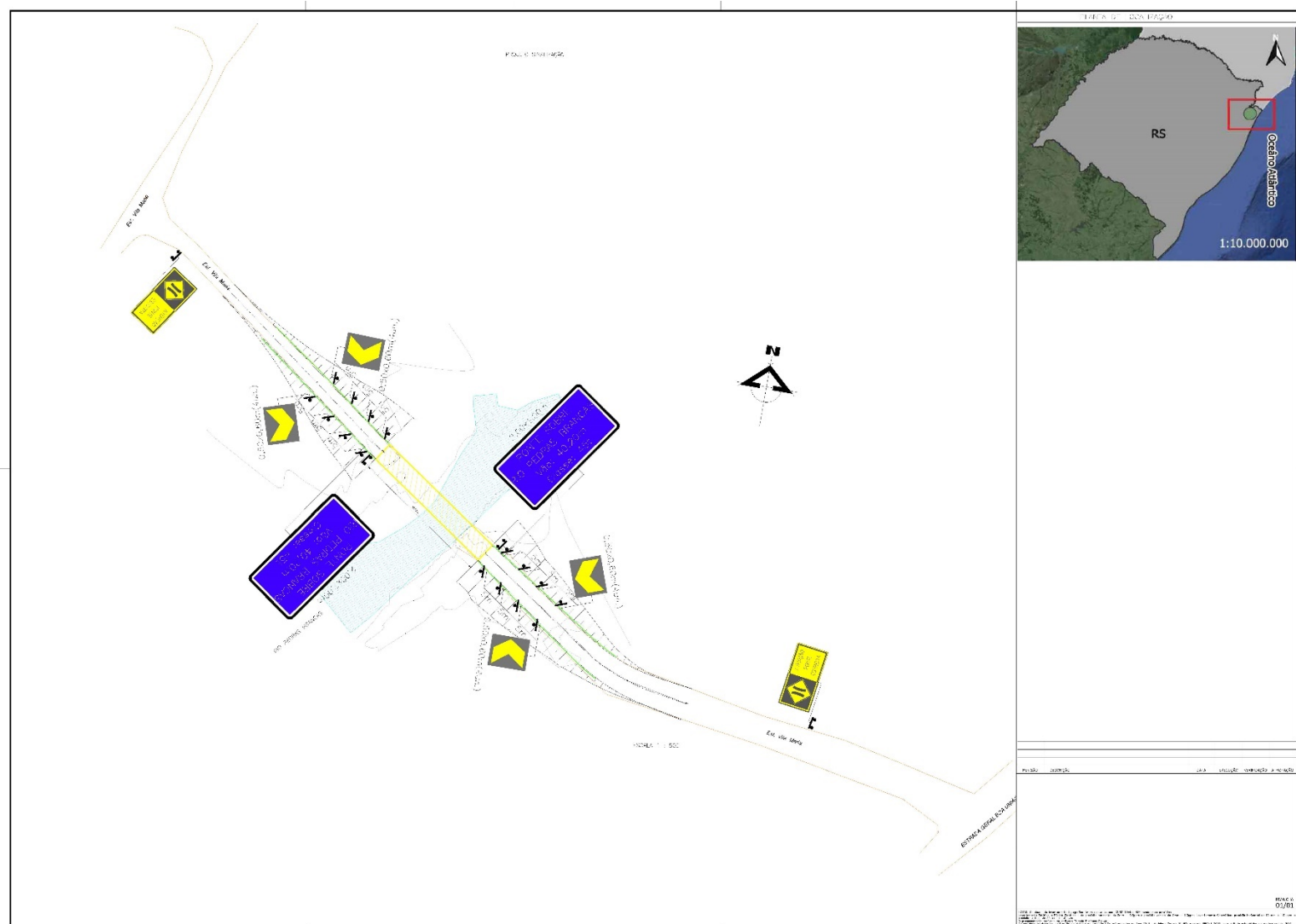
Figura 31 - Sinalização das rampas de acesso a ponte
